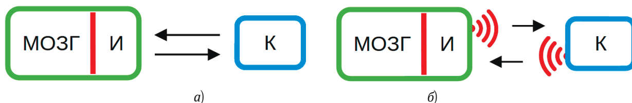
Рис. 7. Современные нейроинтерфейсы: а) взаимодействие между МОЗГом и компьютером (К) через имплант по проводам; б) беспроводной интерфейс МОЗГ — компьютер.
